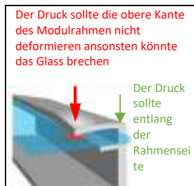
Abbildung 1a: Druck auf die Klemmenstellen
